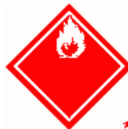
Feuergefährlich (Entzündbare flüssige Stoffe, z.B. Benzin) (4)
